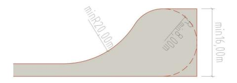
FIGURE 5 RECOMMENDED TURNAROUND LOOP
